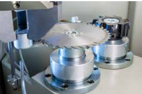
Modell HN-SF mit Spezialsägeblatt und Planfräser
