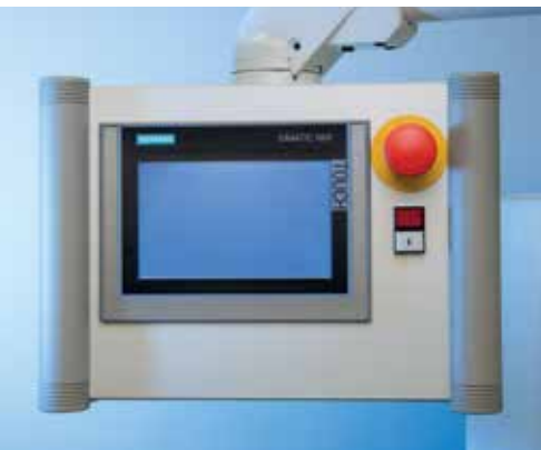
Bedienterminal mit Display für Parameterwahl und Programmauswahl
