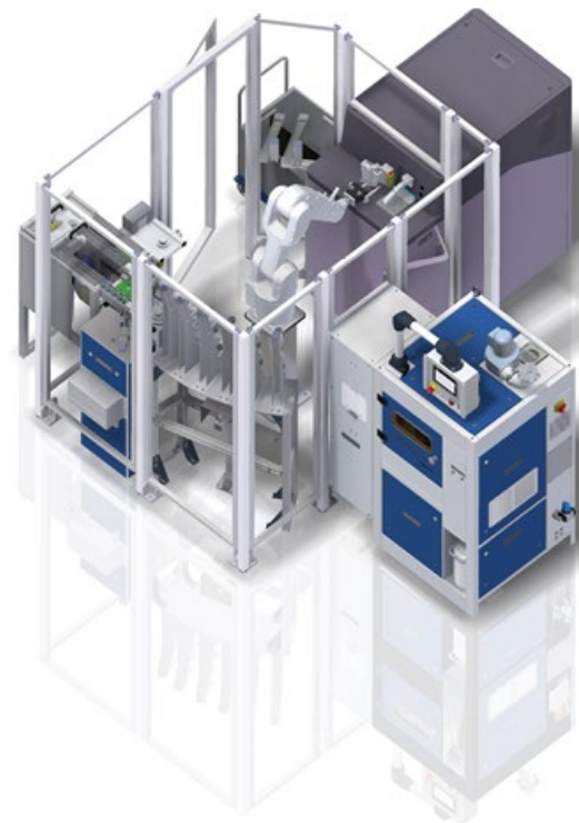
HERZOG MetalLab – Die Standardautomation für die Bearbeitung und Analyse von Nichteisen-Proben
