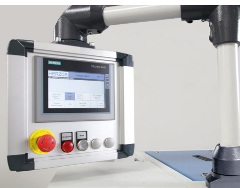
Einfach einstellbares Tragarmsystem des Bedienpanels
