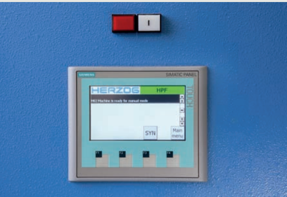
Panel für die Einstellung der Fräsparameter
