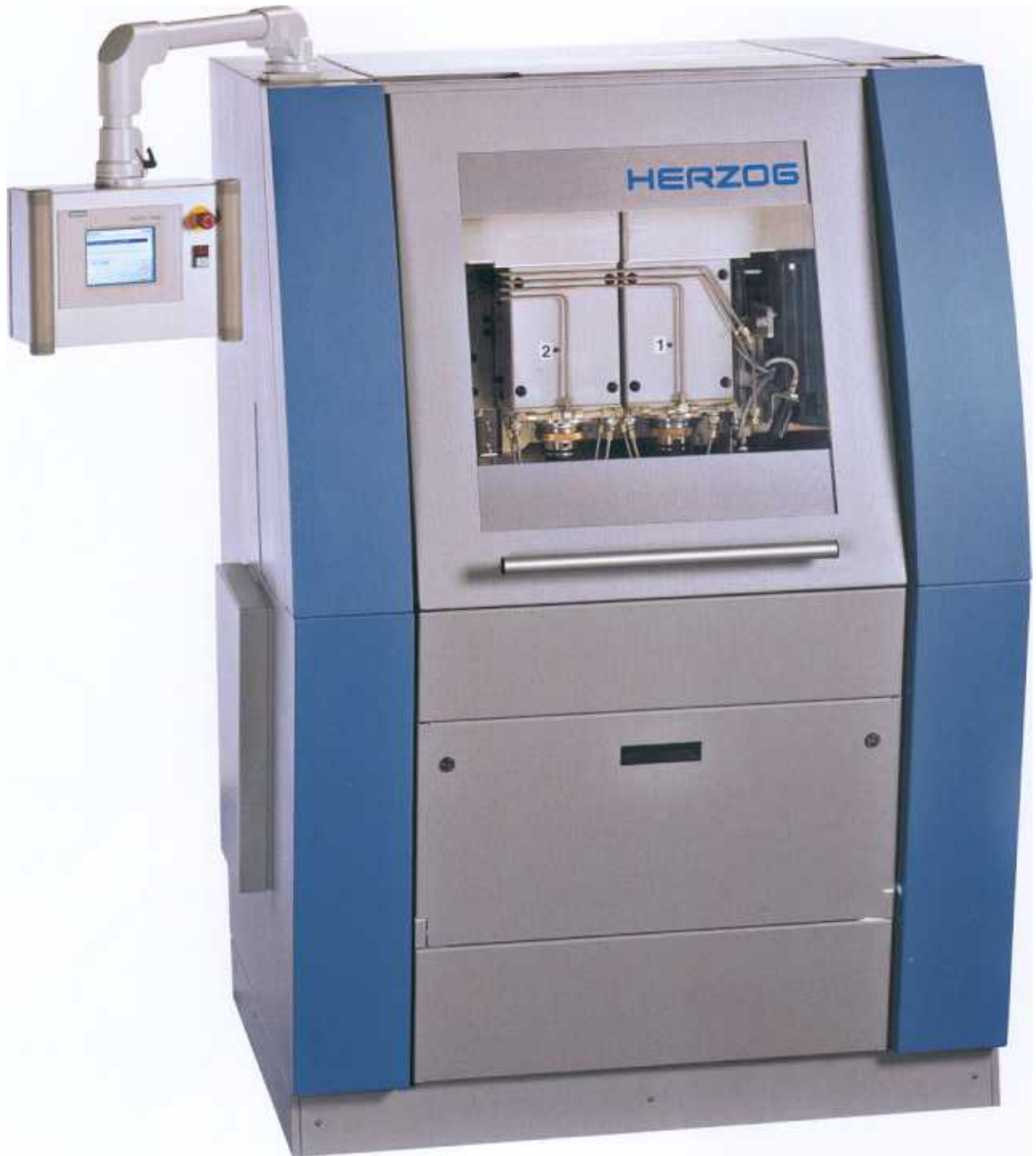
Herzog automatische Probenfräsmaschine HS-FF 2000
