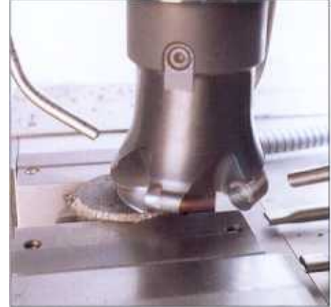
Spezial Fräswerkzeuge mit unterschiedlichen, optimal angepassten Schneidwerkstoffen für alle Materialqualitäten.
