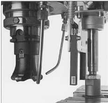
Automatisches Einspannen der Probe und Messen der Probenhöhe.
