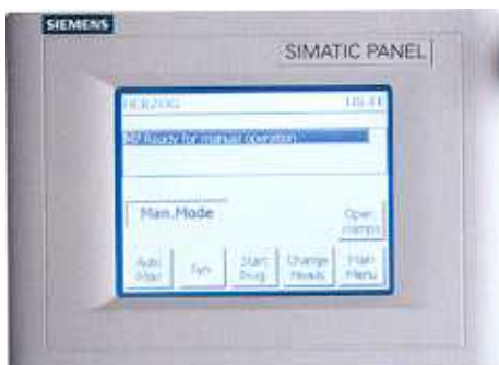
Bedienterminal mit Display für Parameterwahl und Programmauswahl.
