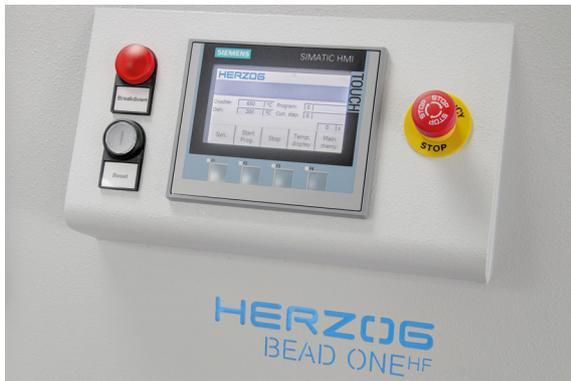
**Einfache Programm- und Parameterauswahl durch das HMI-Panel.**
