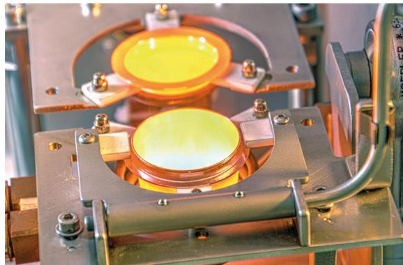
**Gleichzeitiges Aufheizen von Tiegel und Schale**
